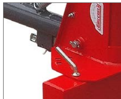
Meccanismo di sicurezza per trasporto su strada Safety mechanism for road transport
