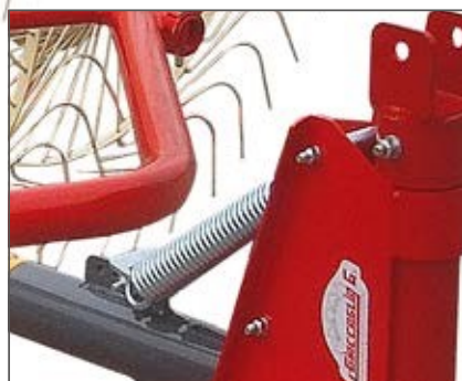
Meccanismo a molle per galleggiamento stelle Spring mechanism for floating finger wheels
